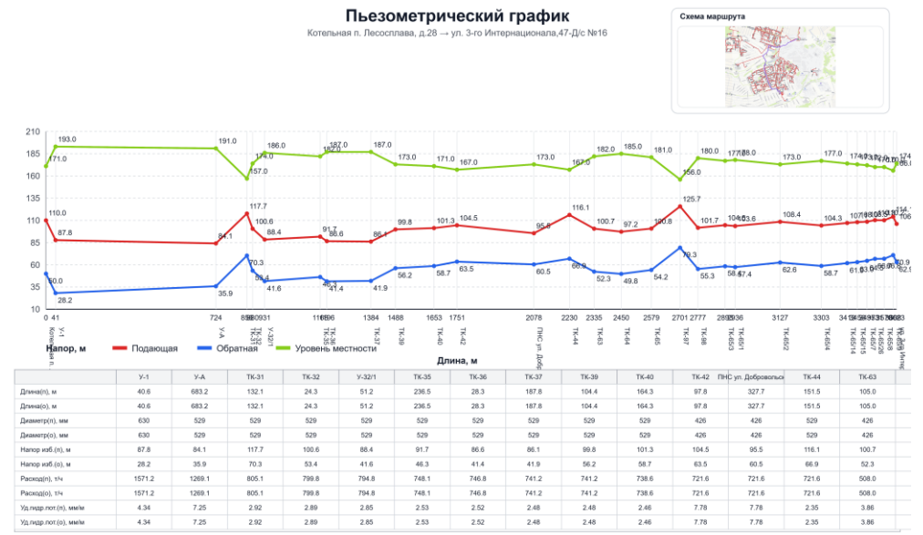
Рисунок 1.3.8.2 - Пьезометрический график: Котельная п. Лесослава, д.28 → ул. 3-го Интернационала,47-Д/с №16
