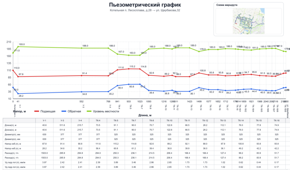
Рисунок 1.3.8.1 - Пьезометрический график: Котельная п. Лесослава, д.28 → ул. Щербакова,32
